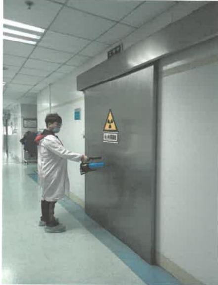
心内导管一室防护门现场检测照片
